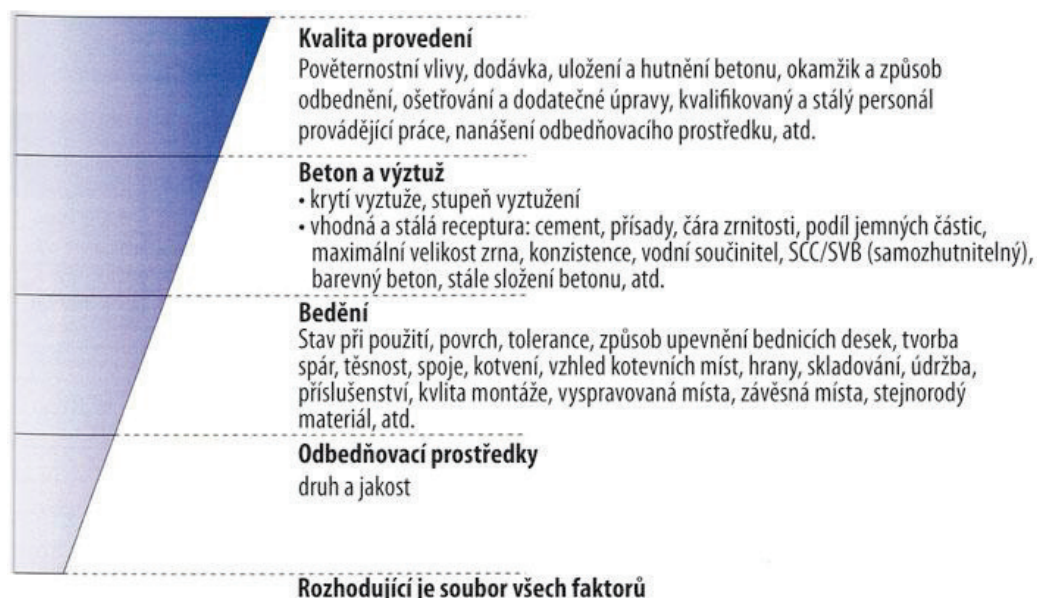
Obrázek 2 Stupně vlivu na výsledný povrch betonu
