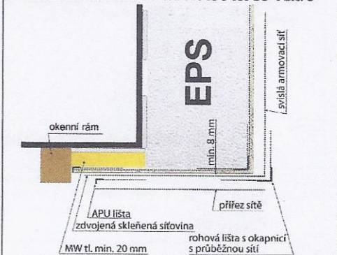
Detail nadpraží a ostění ETICS dle Požárně klasifikačního osvědčení dle ISO 13785-1 alt. 3
