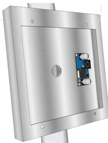
Kovový držák pro čtečku – detail držáku
