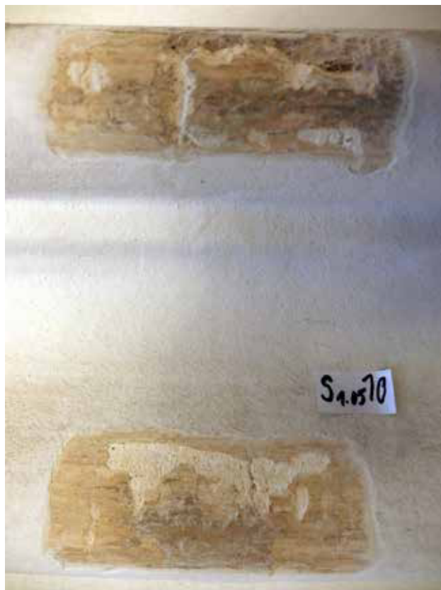
Sondáž stropu - sádrový reliéf s izolační zežloutlou vrstvou na povrchu.
