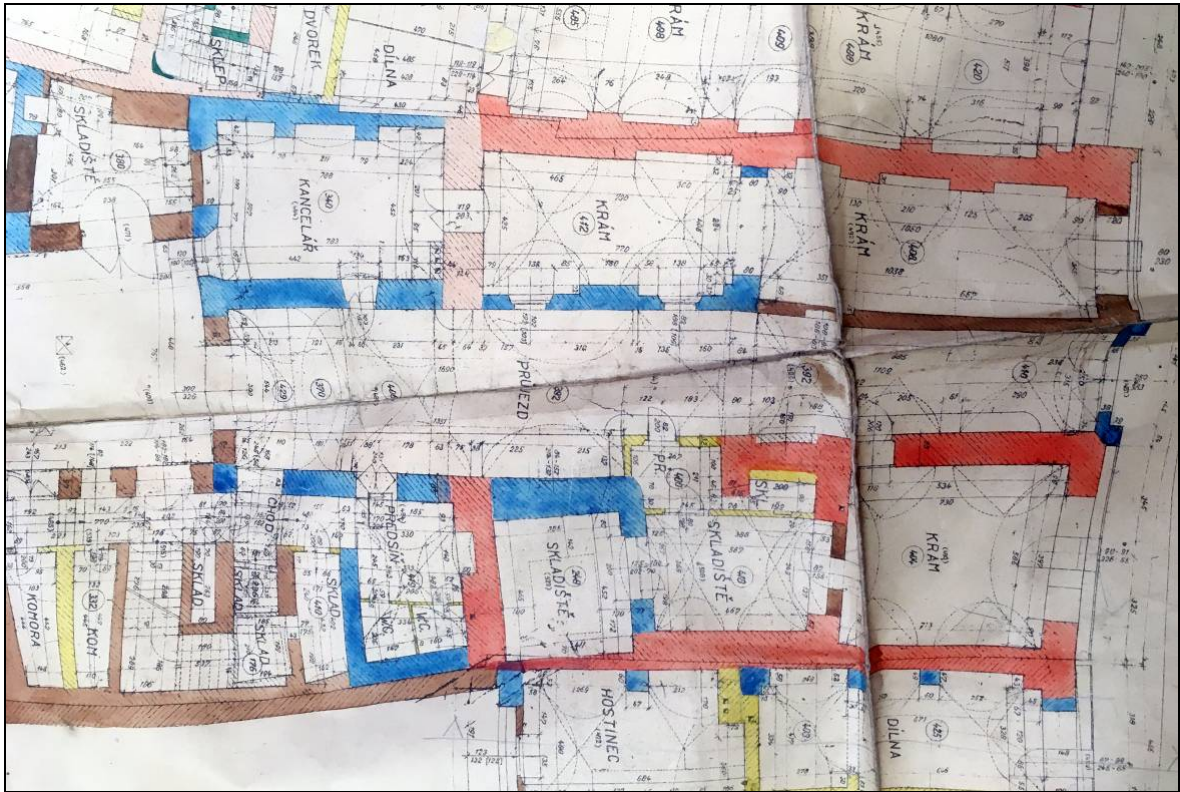
Plán přízemí domu s barevným vyhodnocením stavebního vývoje. Líbal – Lorenc, 1952. Červená – zdivo gotické, modrá – renesanční, hnědá – barokní, žlutá – novodobé (20. stol.).
