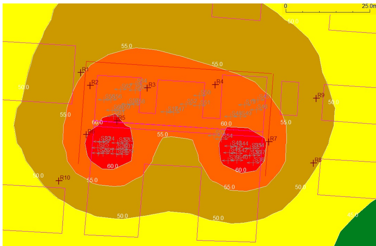
Obrázek 3: Hluk jednotek nad střechou pavilonů Vinohradské nemocnice (6. NP)
