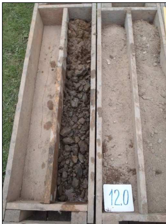
Detail výnosu 12,0 - 13,0 vrtu V3
