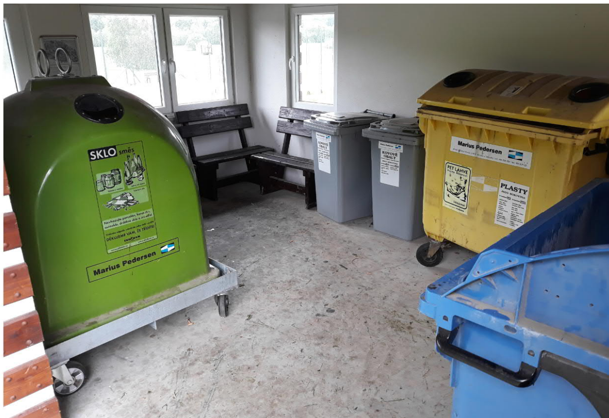
Obr. č. 6: Pomocný podvozek na sklo (aplikace v praxi)
